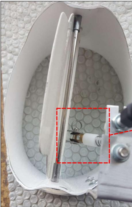
Der "Bowdenzug" wird mit dem Gabelende in die "Kühlerklappe mit großem Lufteinlass" mittels eines "Splintbolzen" montiert und dabei mit einem "Sicherungsring" gesichert.
